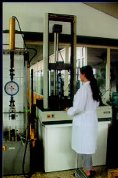
Laboratorio. Máquina de ensayos de tracción
